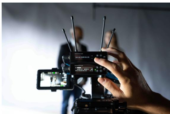
La plaque magnétique du système EW-DP permet d'empiler sûrement et facilement plusieurs récepteurs. Une fixation fournie permet aussi de porter la plaque à la ceinture pour suspendre le récepteur ou le fixer au sac du son
